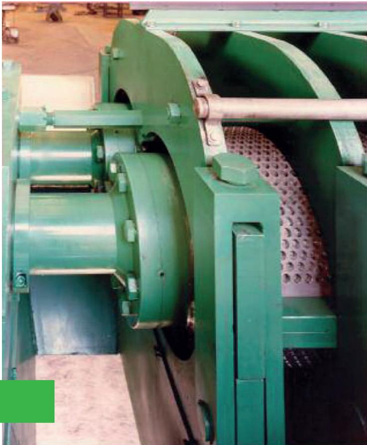
Se utiliza la prensa de doble tornillo con vistas a separar agua y grasa del material sólido precalentado.
