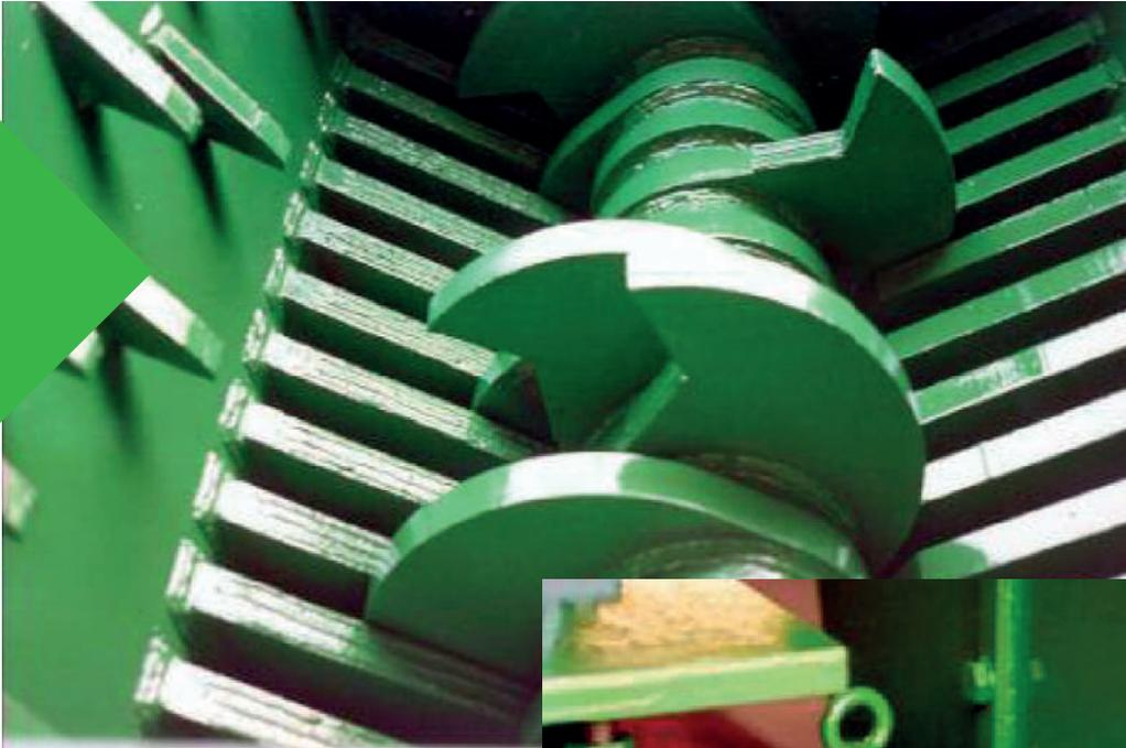
O compartimento dos rolamentos é composto por duas peças para fácil manutenção e troca dos rotores.
